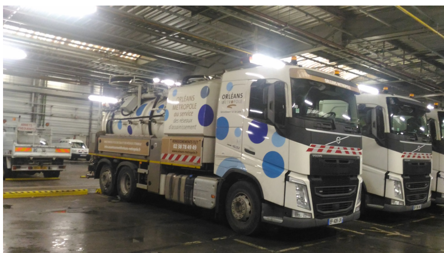
Camions hydrocureurs de la DCERE
