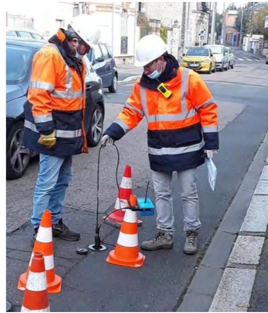
Recherche de fuite par écoute acoustique
