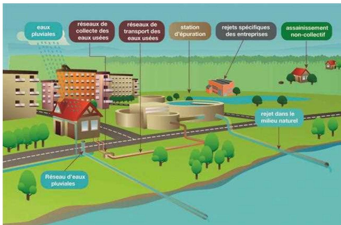
Le cheminement des effluents (source ADEME)
