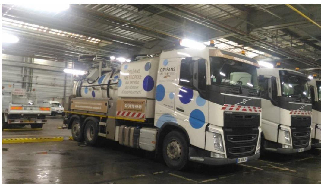
Camions hydrocureurs de la DCERE
